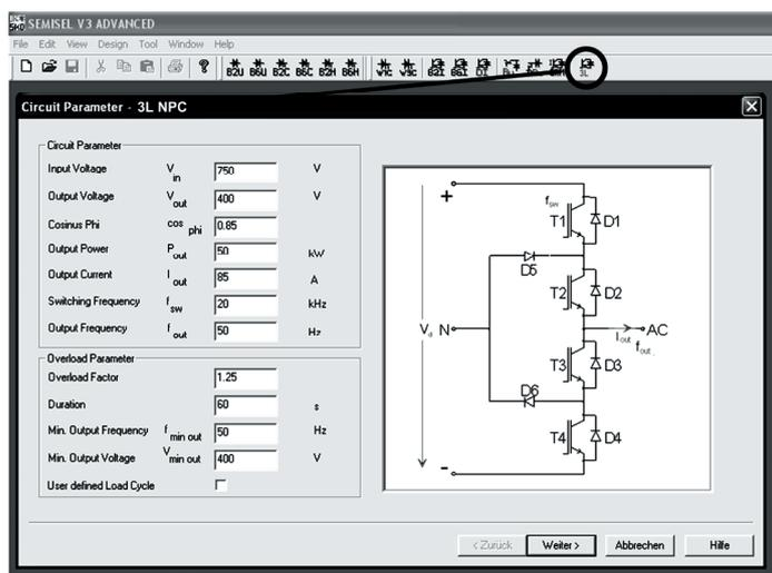
Рис. 3. схемой 3-уровневого преобразователя с фиксирующими диодами 3L NPC
