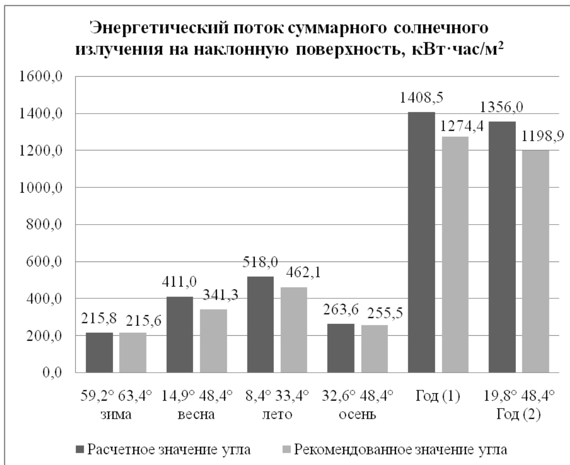
Рис. 1. Результаты поиска оптимальной ориентации приемной поверхности по углу: (1) – угол регулируется посезонно; (2) – угол неизменный
