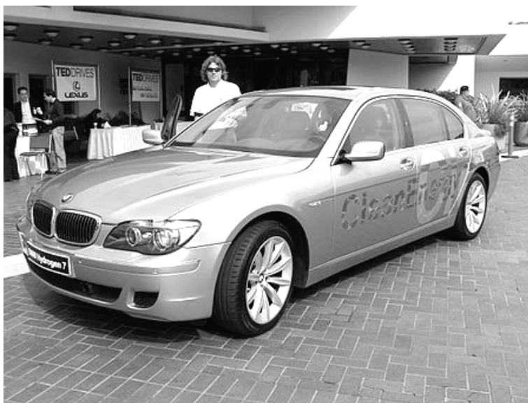
Рис. 3. Внешний вид битопливного автомобиля BMW Hydrogen 7 – (бензин / жидкий водород)
