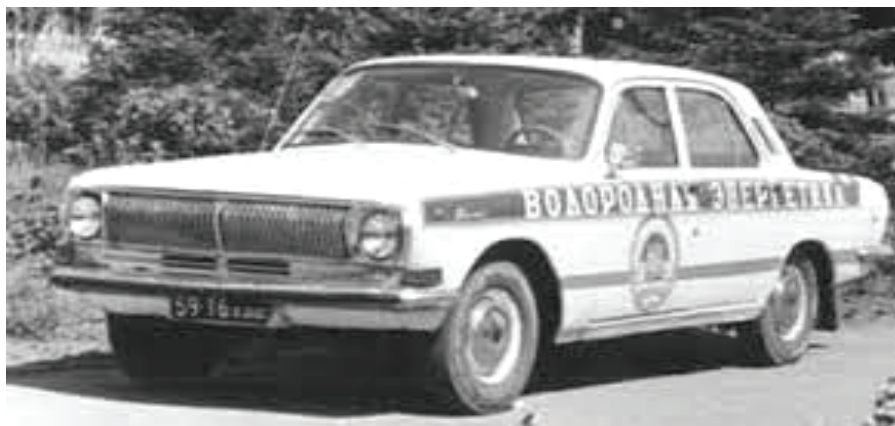
Рис. 4. Внешний вид бензо – водородного автомобиля «Волга»
