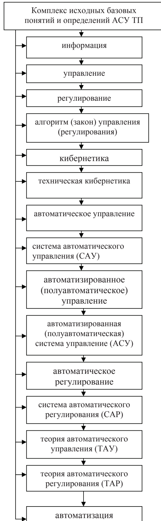
Рис.1. Иерархическая структура базовых понятий и определений по АСУ ТП
