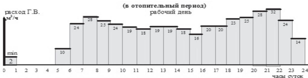
Рис. 1. График расчетного расхода горячей воды за сутки (408 м³/с)
