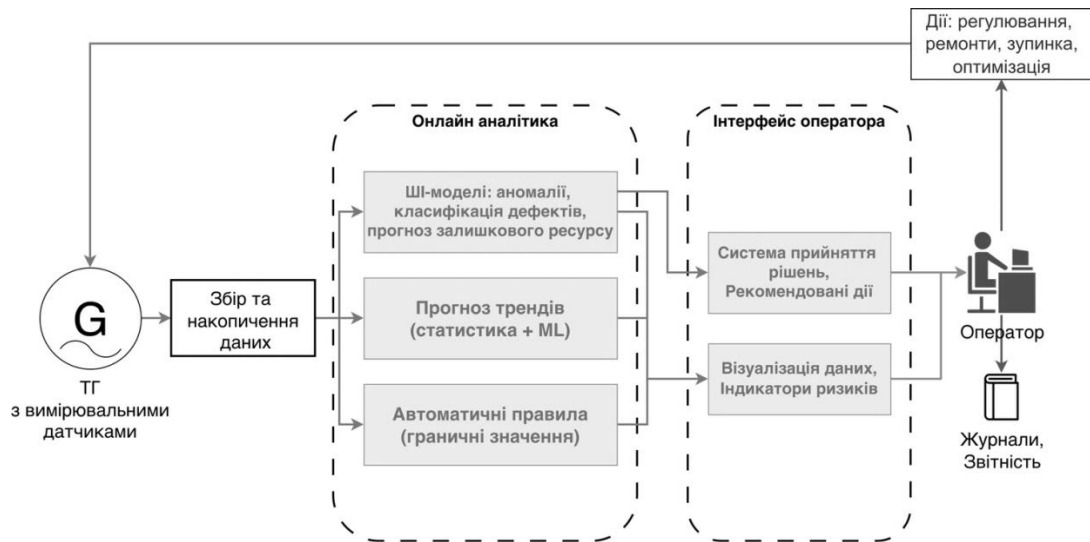
Рисунок 4 – Другий блок організації контролю стану ТГ з системою аналізу даних в режимі реального часу та прийняття рішень
