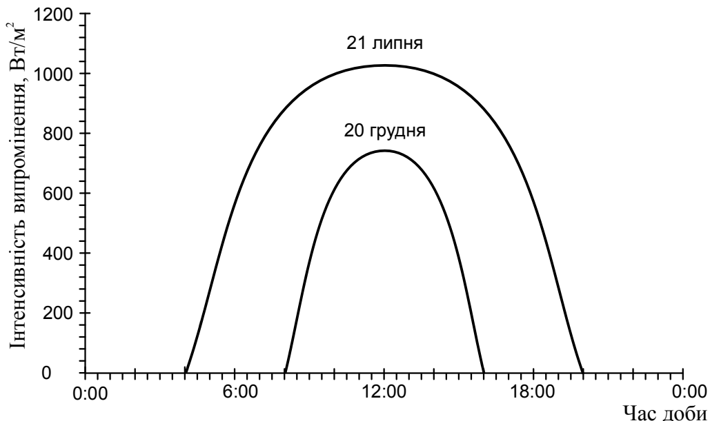
Рис. 2. Інтенсивність сонячного випромінювання для ФЕС з системою стеження на 50^\circ пн. ш.
