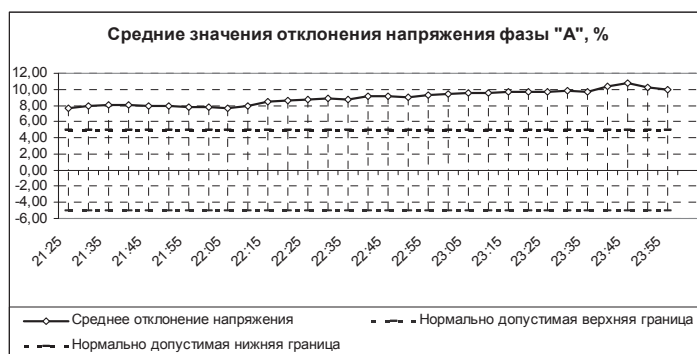
Рис. 2. Отклонение напряжения в сетях КП «Харьковгорсвет»
