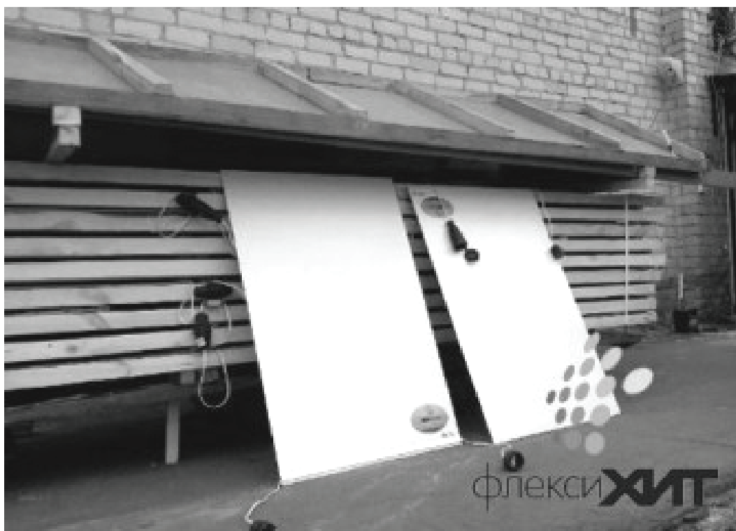
Рис. 3. Инфракрасная сушка пиломатериалов на открытой площадке с помощью кассетной сушилки ФлексиХИТ
