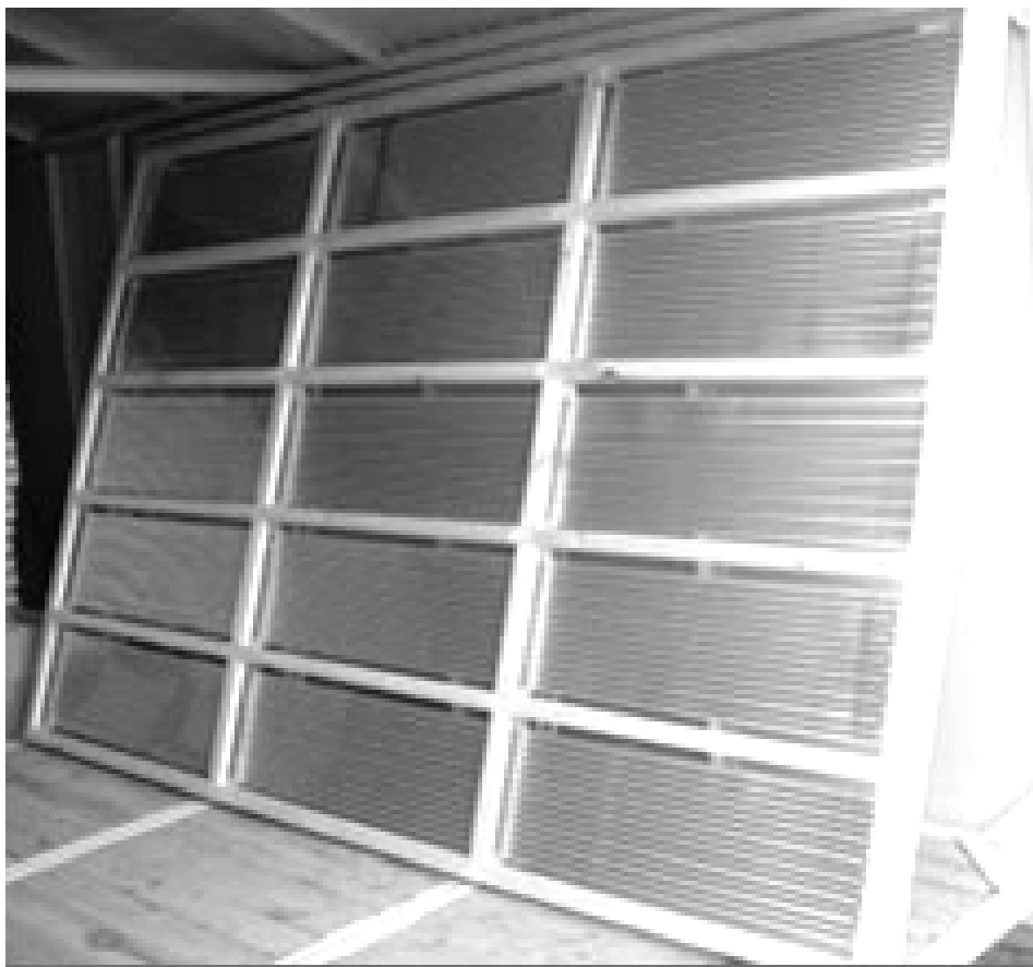
Рис. 2. Общий вид щита с закрепленными на нем пленочными инфракрасными электронагревателями
