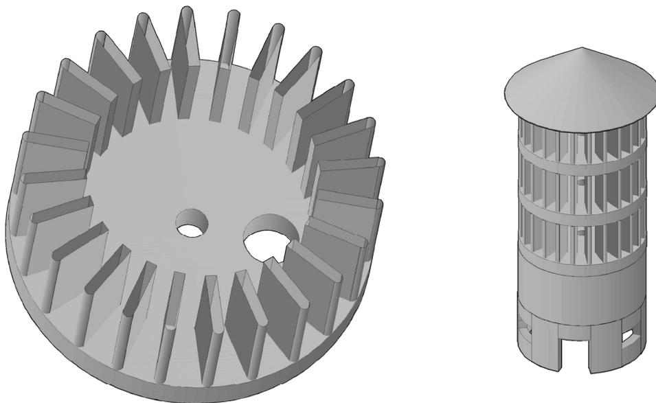
Рис.2. Железобетонная внешняя конструкция ветроустановки и ее отдельное звено
