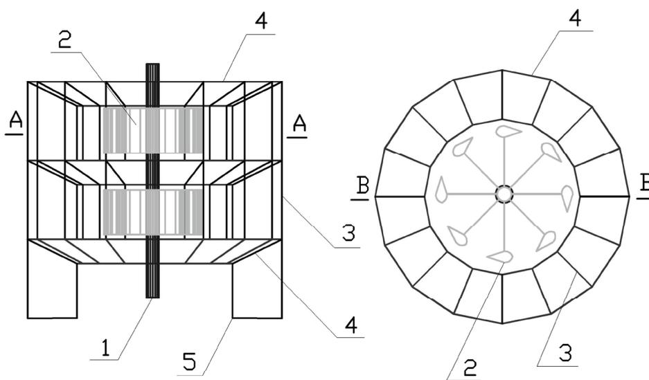
Рис.1. Вертикально-осевая ветроустановка:
