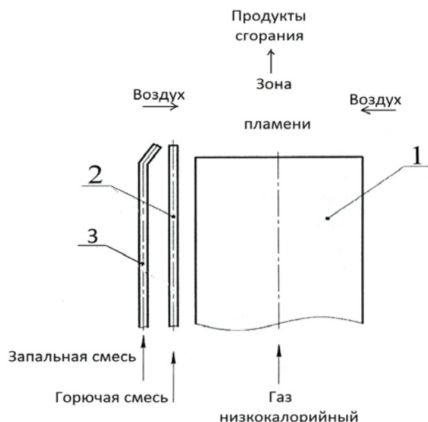
Рис. 2 Схема розжига сбросных газов с помощью "бегущего огня": 1-факельный оголовок; 2 – трубопровод горючей смеси; 3 – трубопровод запальной смеси
