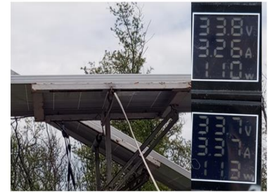
Рисунок 1 – Дослідження впливу зміни кута нахилу СФП в хмарну погоду на генеровану потужність.
